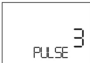
fig.11 réglage des impulsions pour chaque tour de roue
