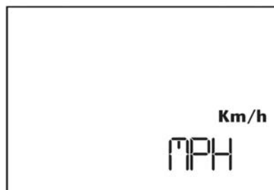
fig.10 réglage de l'unité de mesure
